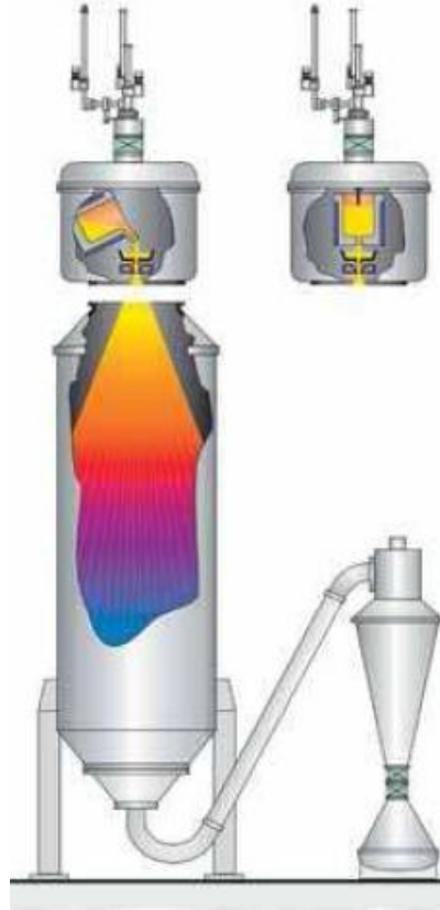
شکل ۲-۵: ذوب القایی خلأ و اتمیزه کردن تحت گاز بی اثر [۳۰].
