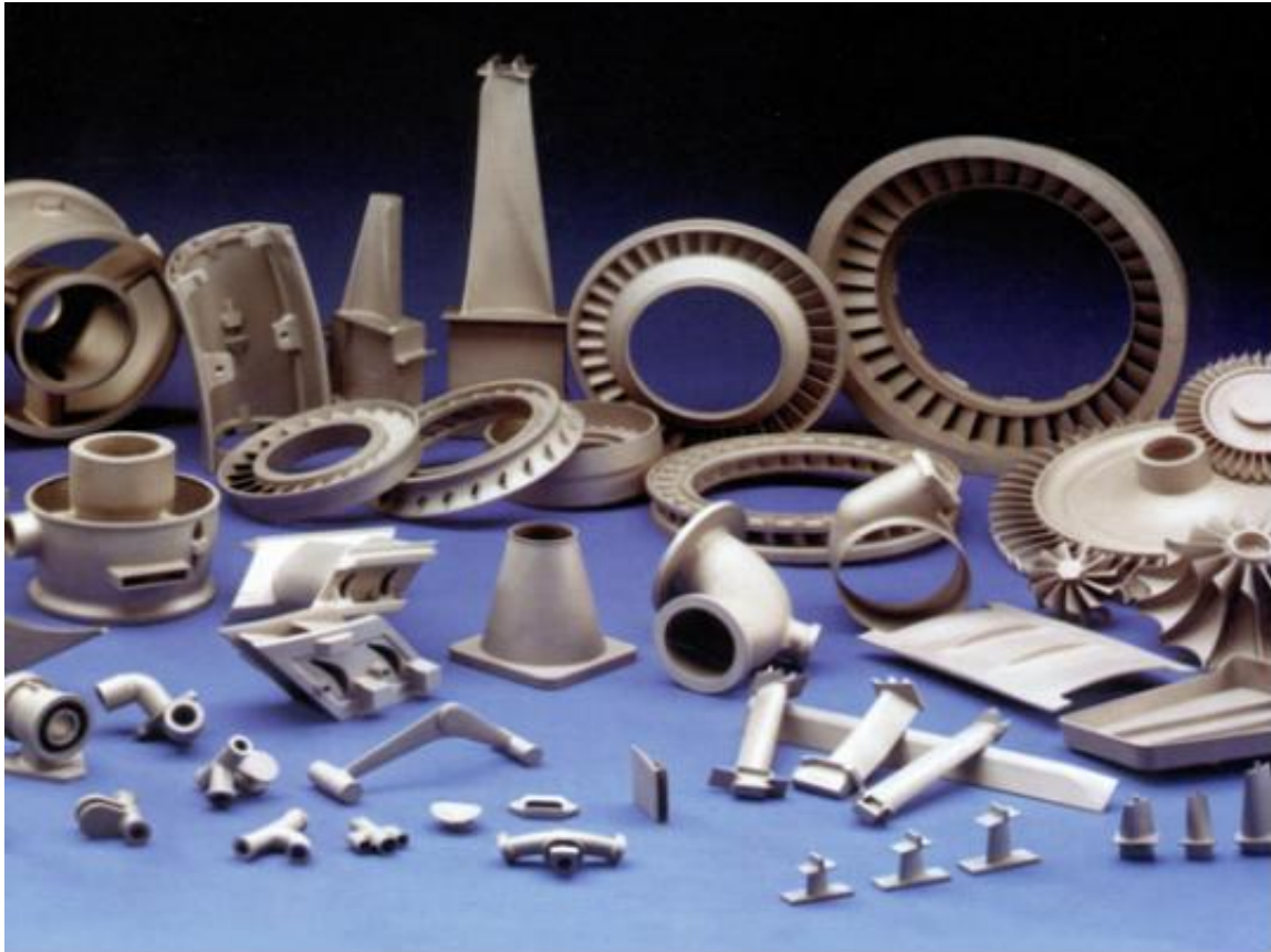
شکل ۱-۲۳: تعدادی از قطعات سوپرآلیاژی ریختگی مورد استفاده در توربین های گازی [۲۳].
