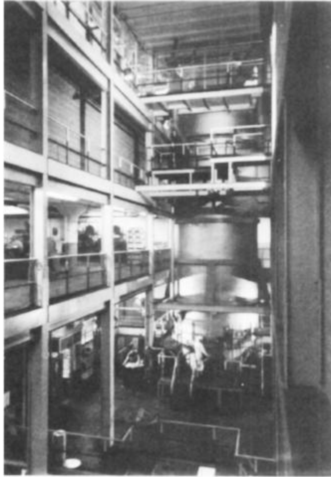
شکل ۲-۳۵: تولید پودر از طریق اتمیزه تحت خلأ [۴۵].
